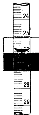
Рис. 32. Экран для отсчета показаний по бюретке.
