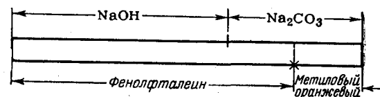
Рис. 53. Схема титрования смеси \text{NaOH} и \text{Na}_2\text{CO}_3 раствором \text{HCl} с фенолфталеином и метиловым оранжевым.
